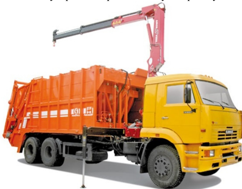
Рис. 4. Мусоровоз с крано-манипуляторной установкой (КМУ)
