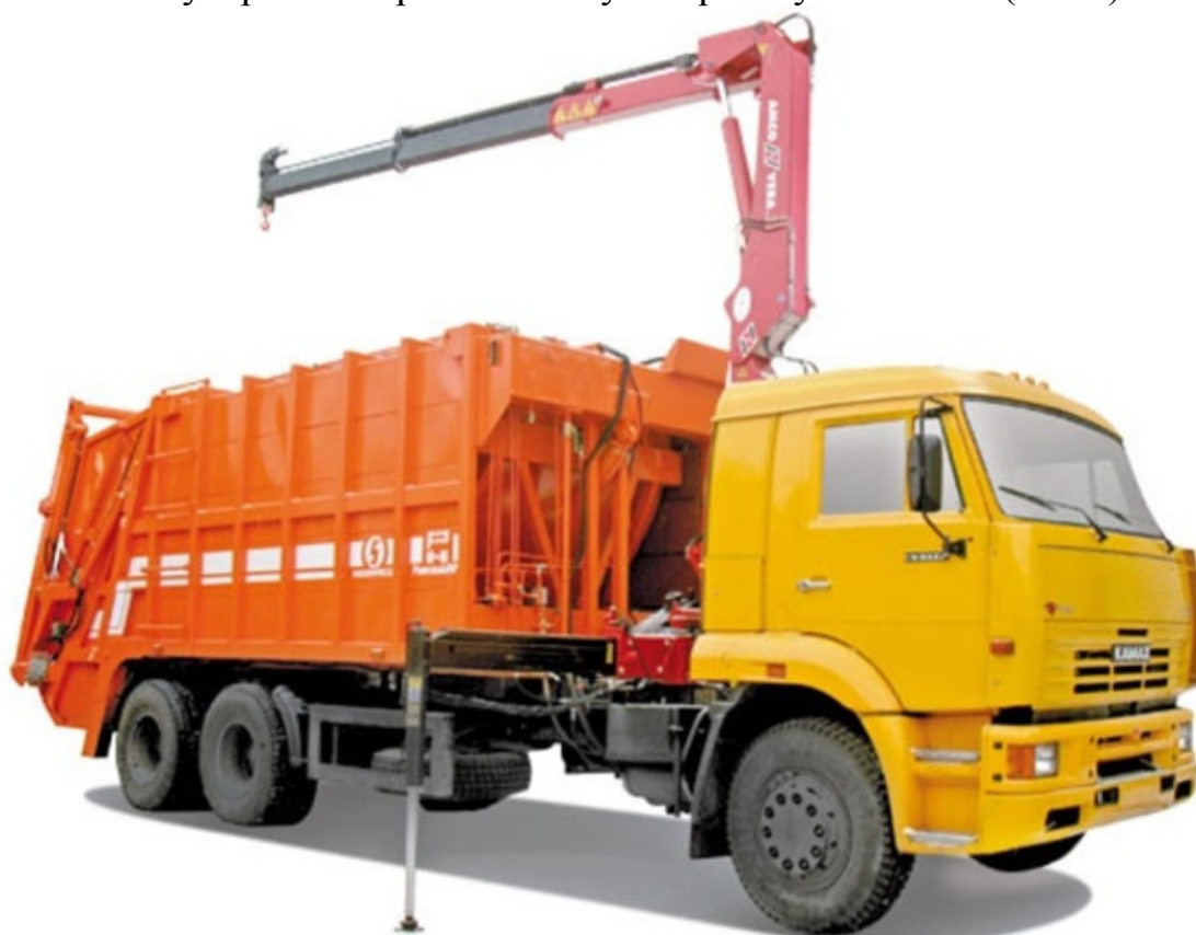
Рис. 4. Мусоровоз с крано-манипуляторной установкой (КМУ)
