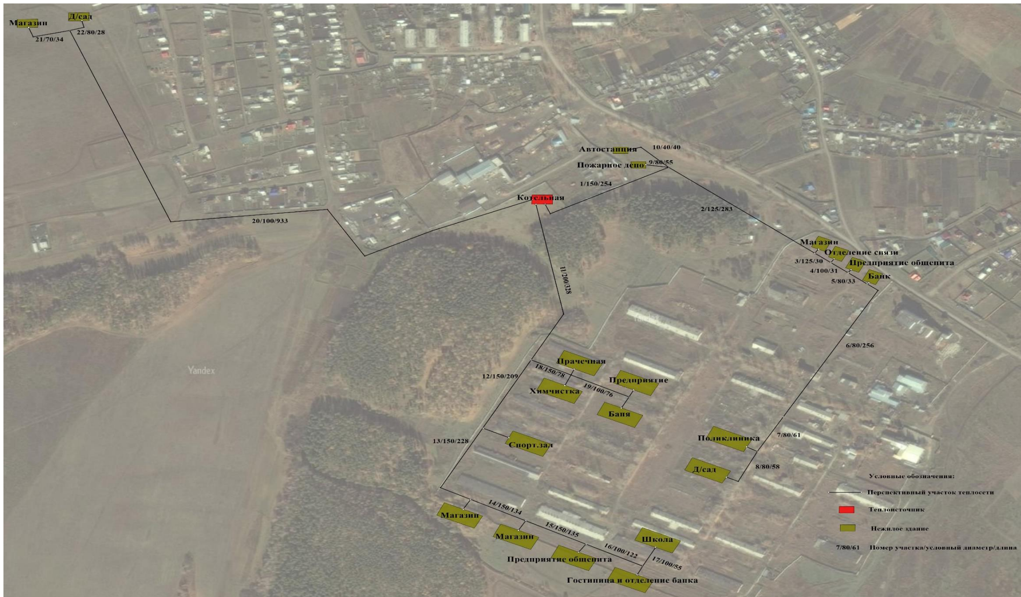
Рисунок 4. Расчётная схема перспективной тепловой сети от котельной Новая.
